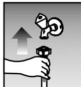
В данную стиральную машину подается только холодная вода. Подключение к водопроводу производится с помощью синего шланга, входящего в комплект поставки.
